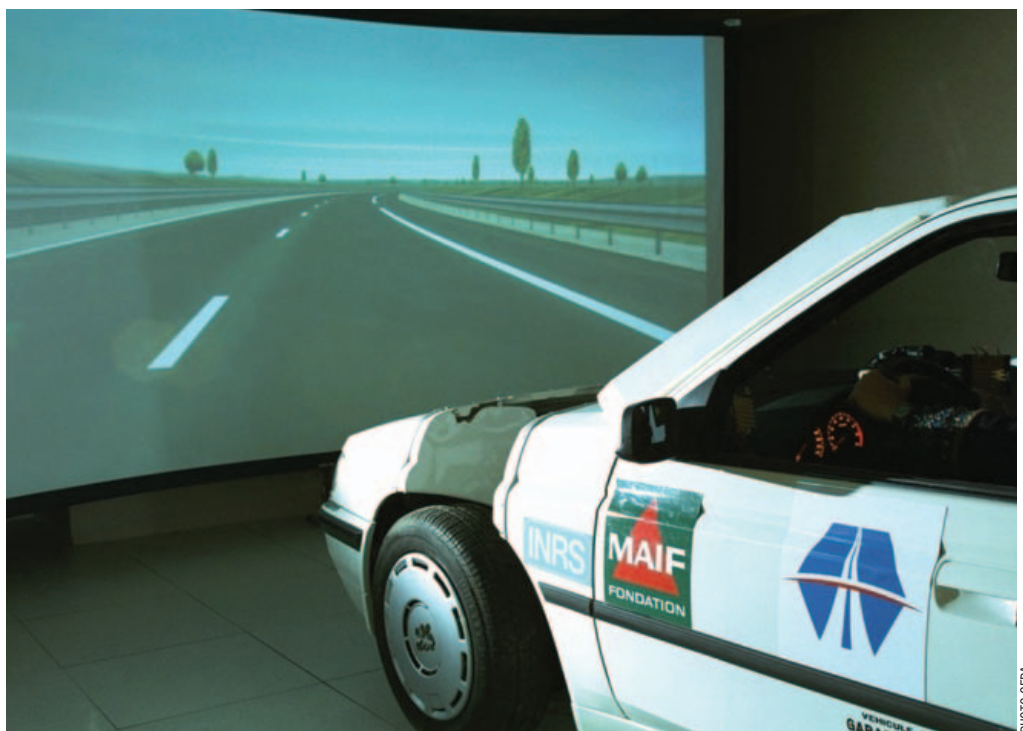
Poste d'analyse de la vigilance en conduite automobile simulée.
