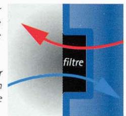
Le filtre de respiration situé à l'entrée du compartiment électrique garantit une propreté particulière et chimique réelle à l'intérieur du luminaire. Il est particulièrement adapté dans les zones de trafic intense.
