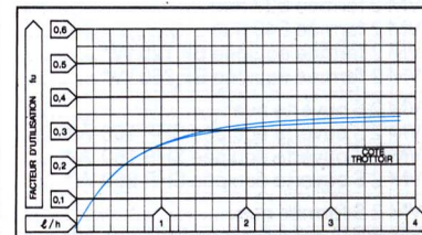
VM 1 fermée 70 W SHP - inclinaison 0°.
