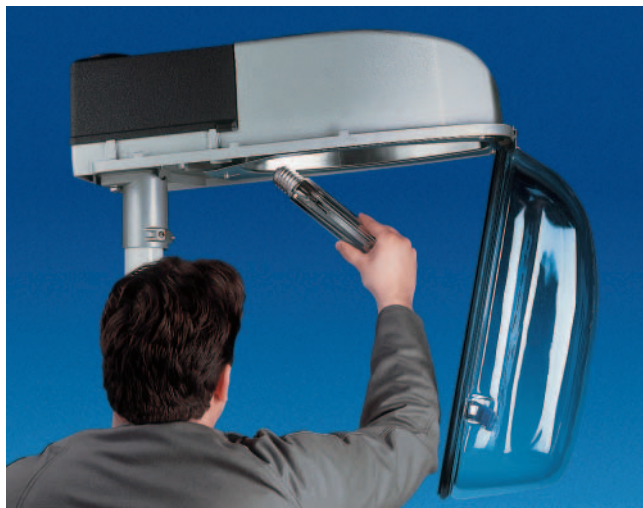
Accès aisé à la lampe en déverrouillant un clip de fermeture en acier inoxydable. Le protecteur ouvert est maintenu par une charnière en acier inoxydable, ce qui facilite les opérations de changement de lampe.
