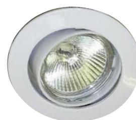
Version orientable (H2). Diamètre 94 mm pour encastrément diamètre 82 mm. IP 20. Hauteur 40 mm.
