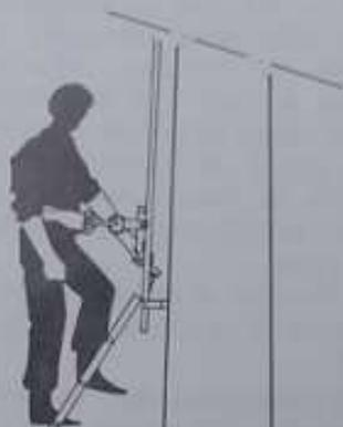
tous nos mâts MEGA ou LOUXOR peuvent être équipés d'une plateforme fixe en acier galvanisé avec accès par échelle métallique
